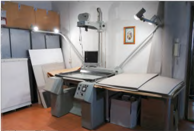
Dokumator – zabytkowe dzisiaj stanowisko do wykonywania kopii mikrofilmowych z dokumentów archiwalnych
