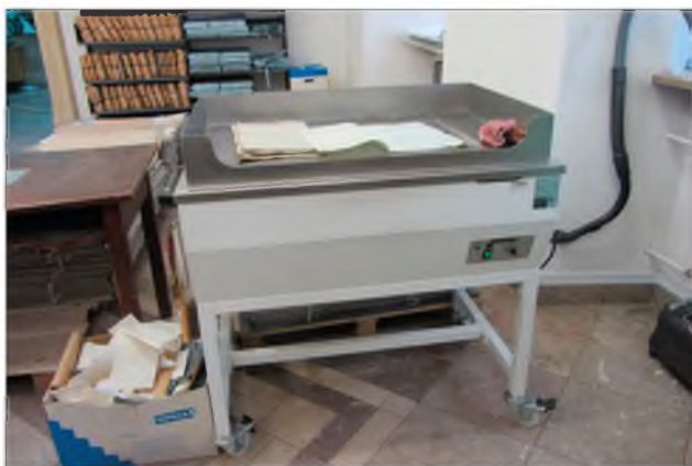
Mobilne stanowisko do odkurzania archiwaliów i materiałów bibliotecznych firmy Preservation Equipment Ltd (Archiwum Narodowe w Krakowie)
