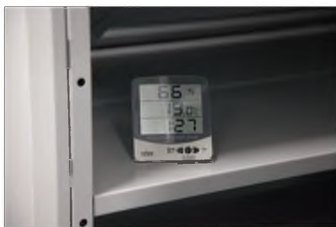
Pomiary klimatu w nowym magazynie powinny być wykonywane wewnątrz bloków regałów. Można się posłużyć prostymi termohigrometrami
