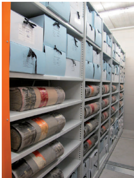
Magazyn akt. Regały jezdne o zmiennym położeniu półek, przystosowane do przechowywania akt w pozycji leżącej. Archiwum Narodowe Estonii w Tartu (Noora Rahvusarhiiv), Estonia
