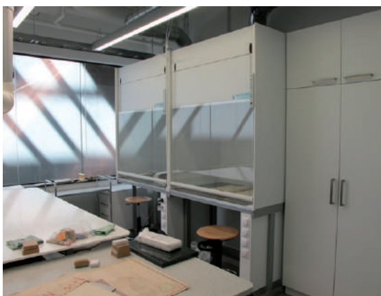
Pomieszczenie do odkurzania i czyszczenia mechanicznego akt wyposażone w komory laminarne z filtracją HEPA w pracowni konserwacji. Archiwum Narodowe Estonii w Tartu (Noora Rahvusarhiiv), Estonia
