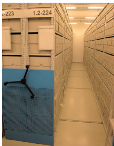
Magazyn akt – regały przesuwne przystosowane do przechowywania akt w pozycji leżącej (siedem półek), z ażurowym, obniżonym panelem bocznym. Brandenburgskie Główne Archiwum Krajowe w Poczdamie (Brandenburgisches Landeshauptarchiv), Niemcy
