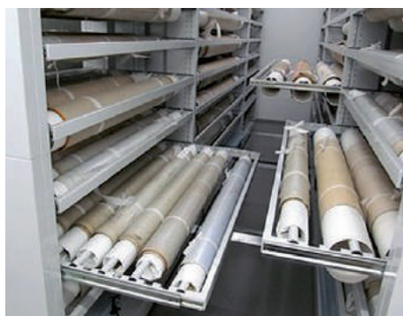
Regały przesuwne przystosowane do przechowywania materiałów na rolkach. Archiwum Narodowe Estonii w Tartu (Noora Rahvusarhiiv), Estonia (fot. Ruth Tidor)
