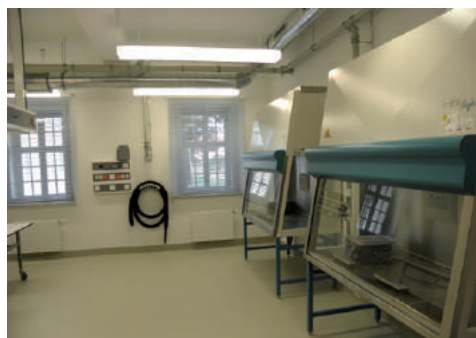
Pomieszczenia akcesji z komorami laminarnymi (do czyszczenia archiwaliów), ruchome stoły robocze oraz odkurzacz centralny. Centrum Konserwacji Archiwaliów i Zbiorów Bibliotecznych Archiwów Saksonii w Wärmsdorf (Archivzentrum Hubertusburg), Niemcy
