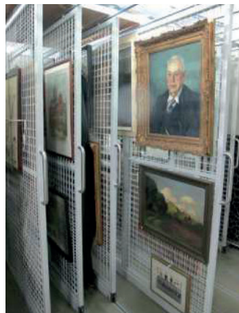
Przesuwne i wysuwane siatki do zawieszania obiektów w ramach lub obiektów wielkoformatowych. Archiwum Regionu Rivierenland w Tiel (Regionaal Archief Rivierenland), Holandia
